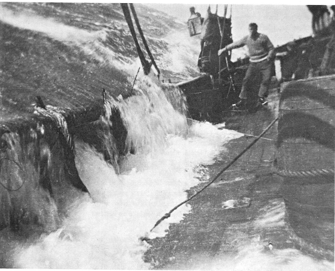
Fig. 20. Miljøskildring fra slupfiskernes tilværelse. Bemærk fiskesnørerne langs rælingen og »kongen« — øjebolten, hvori bomstoppertaljen blev sat fast. Området omkring kongen var den sædvanlige plads for fiskere på deres første tur, det var den socialt laveste plads ombord.
