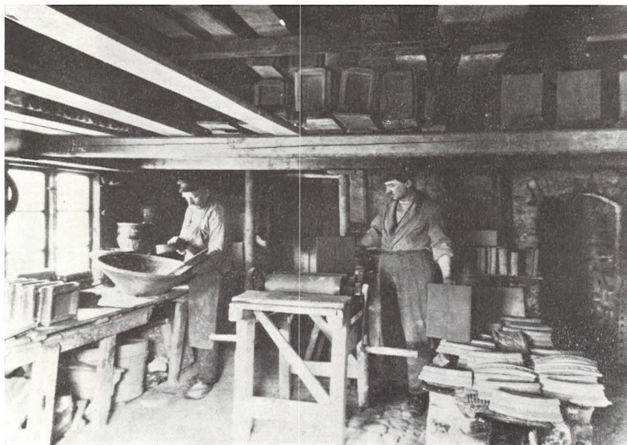
Bild 17. Frithiof Sjöbergs kakelugnsmakareverkstad på 1910-talet. T. v. Elof Hindström glaserande ett kakel och i mitten på bilden kakelugnsmakaregesällen Karl Andersson. T. v. om honom lermangeln. Under taket ligger desbräderna på desarna med kakel till tork. Längst t. h. ingången till brännugnen och framför den simskakel.
