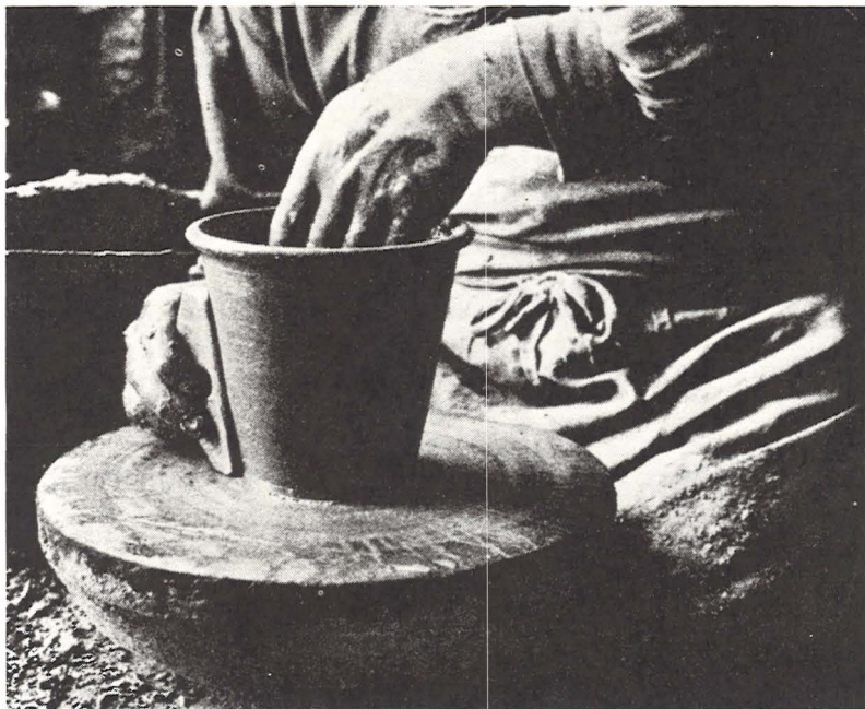
Bild 19. Formning av en blomkruka på drejskivan med hjälp av ett sken. Foto M. Möller. Efter Svenska kultur-bilder, ny följd, bd 5, 1937.
