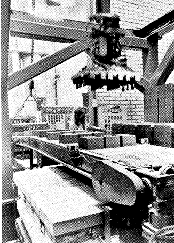
Oumbärligt inom tegeltillverkningen idag är automatik och robotsystem. Här en transferautomat i arbete med det monotona och tidigare fysiskt påfrestande arbetet med transport och stapling av obränt tegel (Foto B. Blom)
